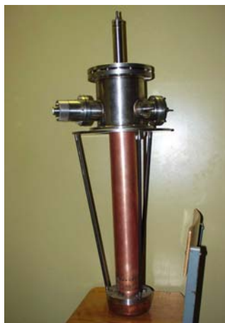
Рис.6.5 Общий вид инжекционного узла триодной ВЧ пушки с резонатором третьей гармоники: 1 – коаксиальный резонатор, 2 – катодно-сеточный узел, 3 – конструктивная емкость, 4 – механизм перемещения плунжера, 5 – верхний электрод ускоряющего зазора ускорителя, 6 – электроды подачи накала инжектора, 7 – подвижный узел связи.
