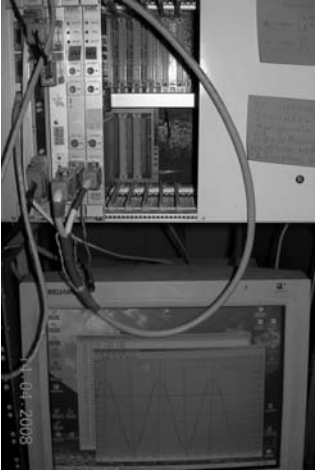
Fig. 20. VME-крейт с аппаратурой.
