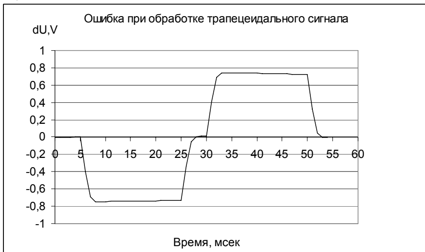
Рис. 11. Ошибка при отработке трапецеидального сигнала.
