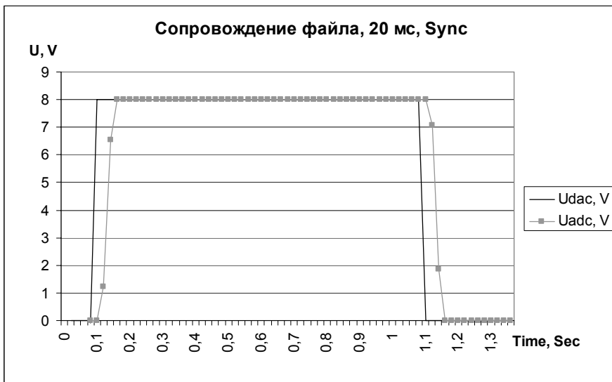
Рис. 6. Оцифровка ступенчатого сигнала при 20 мсек/отсчет.
