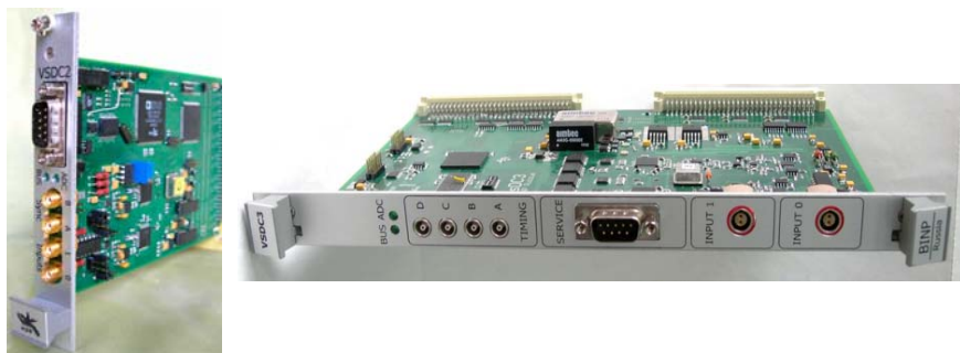
Рис. 7. Фотографии интеграторов VsDC2 и VsDC3.
