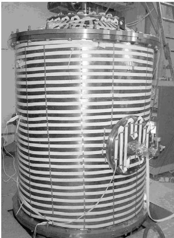
Рис. 2: Вакуумный бак тандема с нагревателями.
