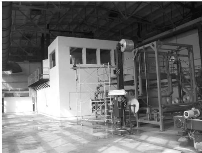
Рис. 4: Бункер ускорителя и часть технологического оборудования в ОАО «Новатэк-Полимер» г. Новокуйбышевск, Россия.
