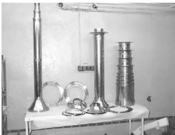
Рис. 6: Элементы внутренней части высоковольтного ввода тандема.
