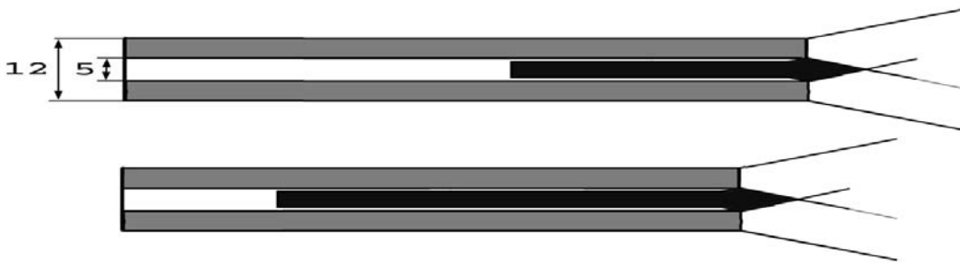
Рис. 1: Постановка эксперимента. Серая трубка - исходный заряд ВВ (длина 240 мм, диаметр 12 мм), черная полоса - положение кумулятивной струи в двух кадрах В и С.
