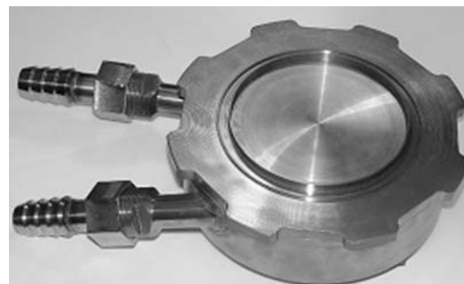
Рис. 9: Мишенный узел в сборе.
