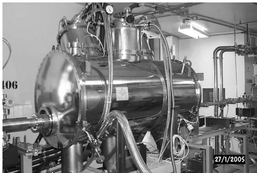
Рис. 16: 63-полюсный вигглер с полем 2.2 Т на накопителе CLS (Канада).
