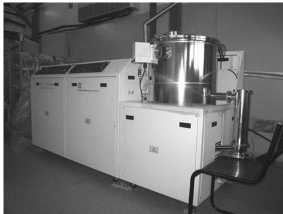
Рис. 9: Оборудование нанесения органических покрытий из газовой фазы. Публикации : [1] ÷ [4], [254], [255], препринты 21.
