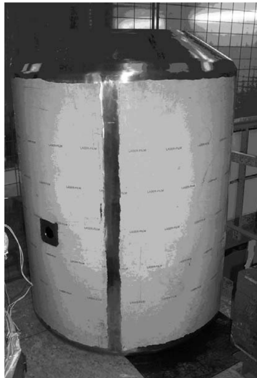
Рис. 3: Цилиндрическая часть электрода (в упаковке).
