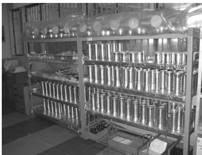
Рис. 5: “Теплые” соединительные узлы вакуумной камеры пучка БАК.
