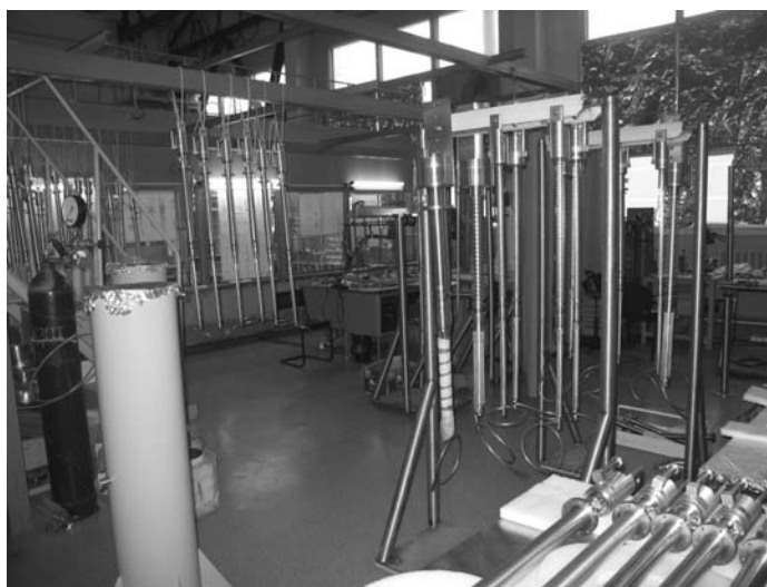
Рис. 6: Сборка токовводов на 600 и 6000 Ампер.
