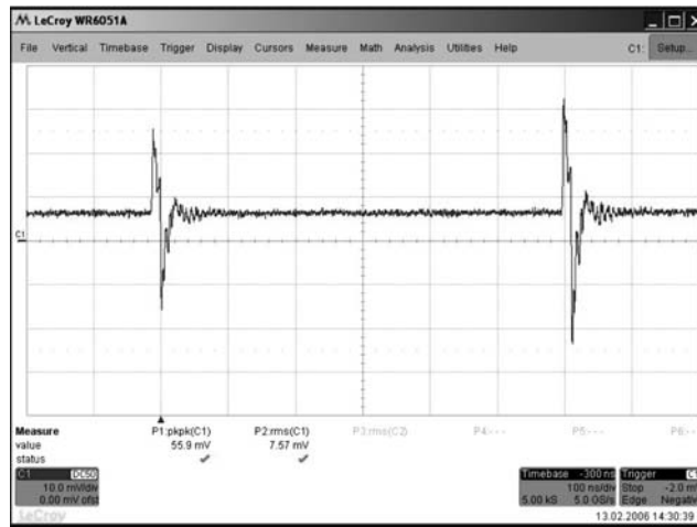
Рис. 13: Сигнал от позитронного пучка (два сгустка), измеряемый с пластин “кикера”.
