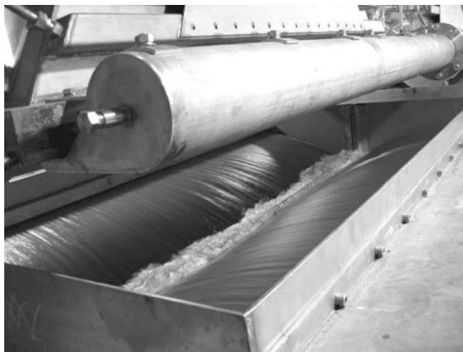
Рис. 1: Обрабатываемая вода под выпускным устройством ускорителя.
