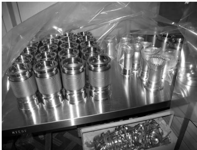
Рис. 4: “Холодные” соединительные узлы вакуумной камеры пучка БАК.
