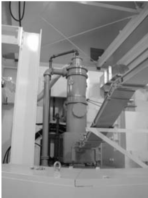
Рис. 1: ВЧ генератор ускорителя ИЛУ-8 в демонстрационном зале МНІ в г. Нагойя (Япония).
