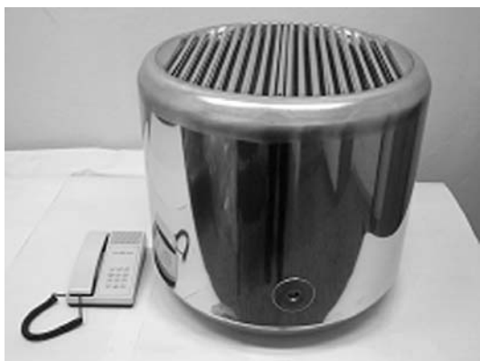
Рис. 4: Высоковольтный электрод тандема.
