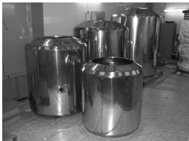
Рис. 2: Электроды высоковольтных ускоряющих зазоров.
