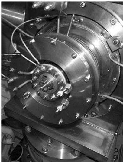
Рис. 3: Фланцевый вариант источника отрицательных ионов водорода.
