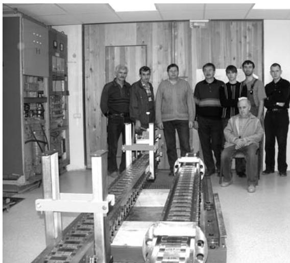
Рис. 19: Первые изготовленные вигглеры-затухатели на постоянных магнитах для Petra-III на стенде магнитных измерений.
