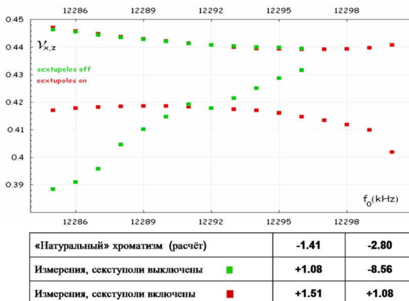
Рис. 14: Измерение хроматизма
