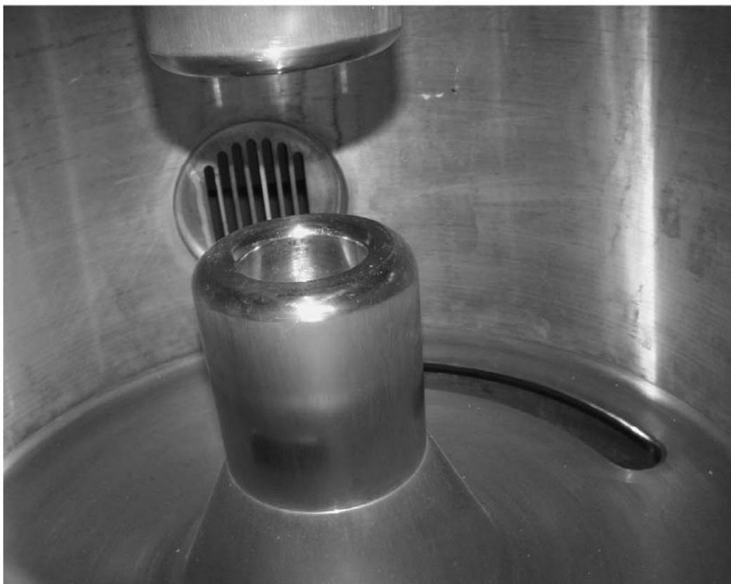
Рис. 3: Внутренний вид ускоряющей ячейки структуры.
