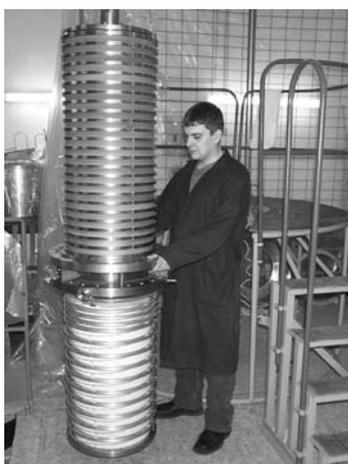
Рис. 1: Стеглянно-керамический проходной изолятор на напряжение 1 МВ.
