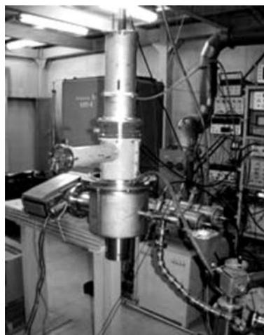
Рис. 3: Стенд испытания вводов мощности.
