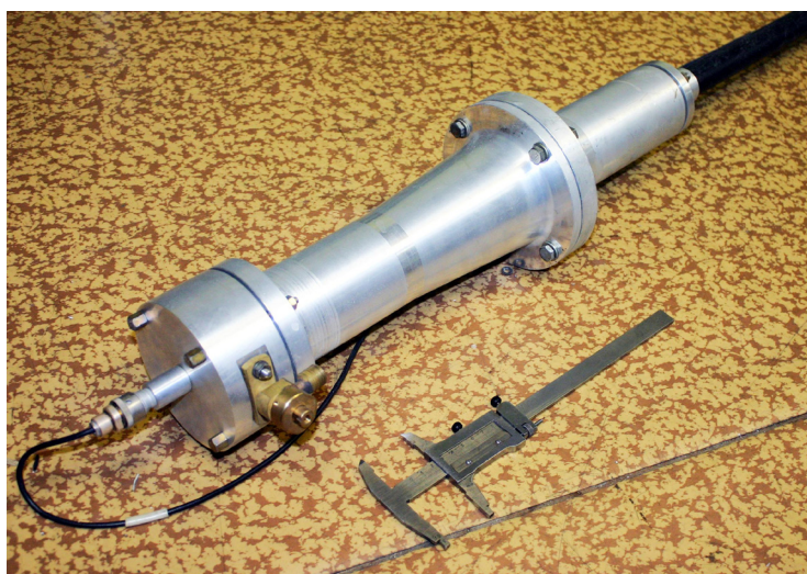
Рис. 4. Высоковольтная широкополосная нагрузка со встроенным делителем.
