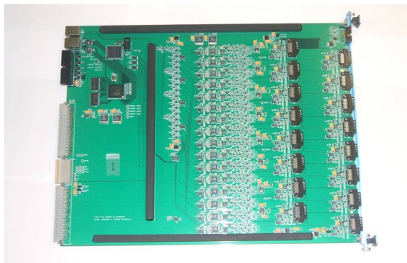
Рис. 4. Электронный модуль формирователя-оцифровщика в стандарте VME на 16 каналов и электронный модуль концентратора в стандарте VME.
