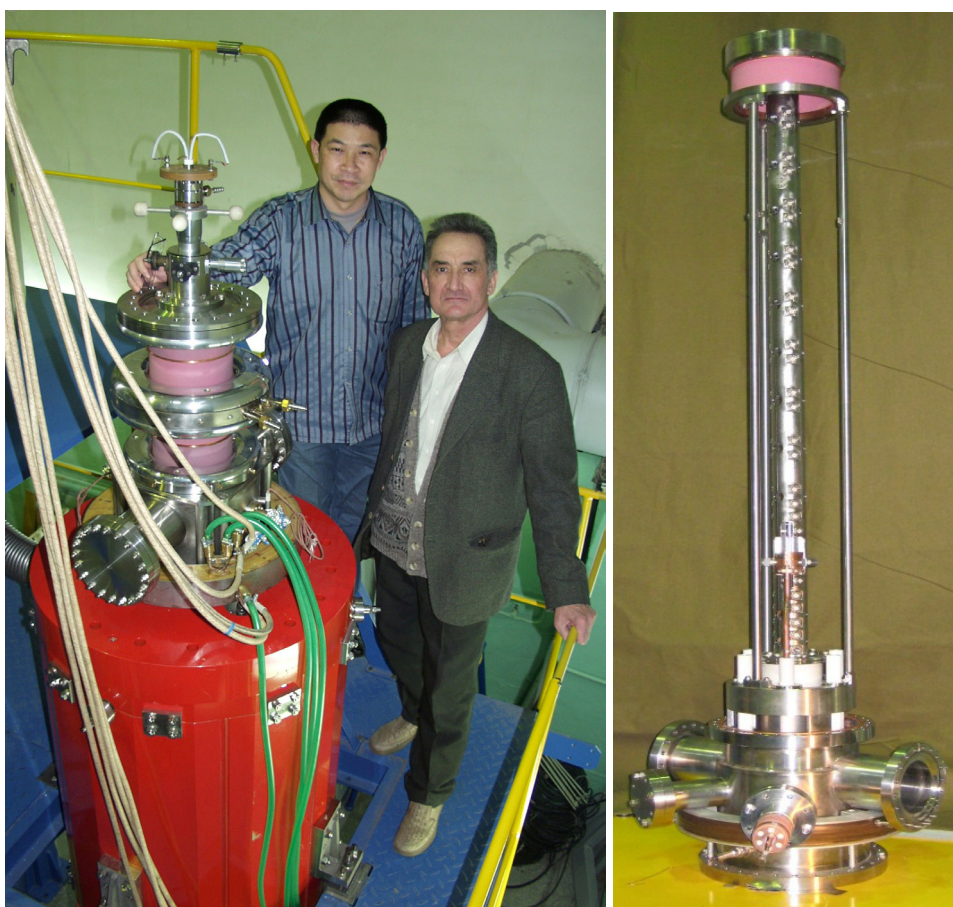
Рис. 2. Источник MIS-1 (слева) и его дрейфовая камера (справа).
