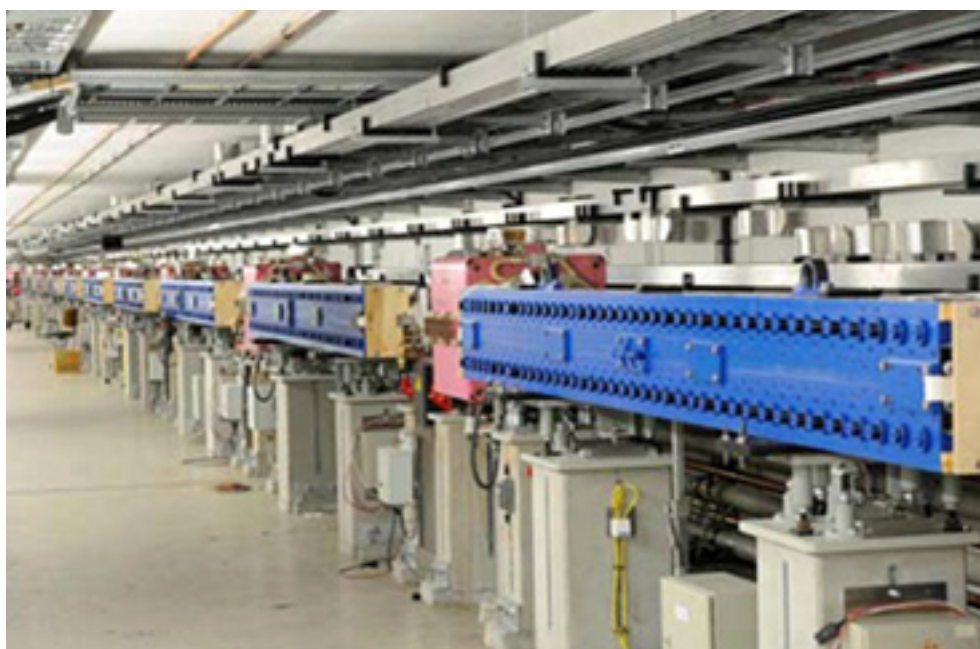
Рис. 36. Вигглеры производства ИЯФ в прямолинейных промежутках PETRA-III.
