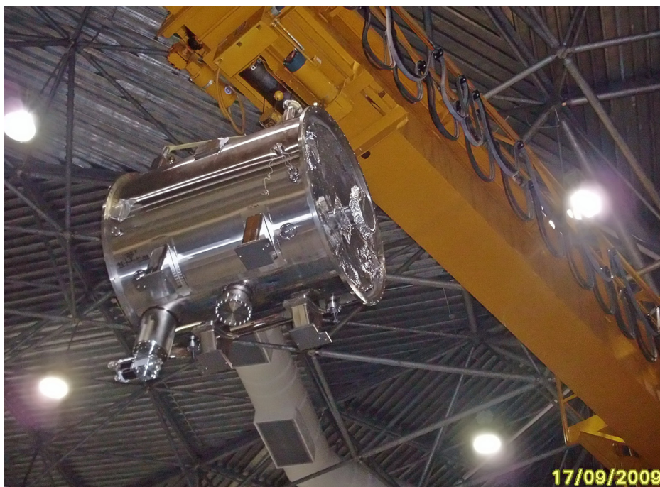
Рис. 33. Процесс переноса на накопитель LSU-CAMD модернизированного шифтера с полем 7,5 Т.
