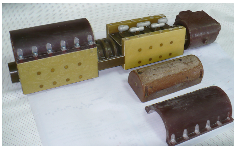
Рис. 13. Фотография сильноточного коммутатора, изготовленного в ИЯФ.
