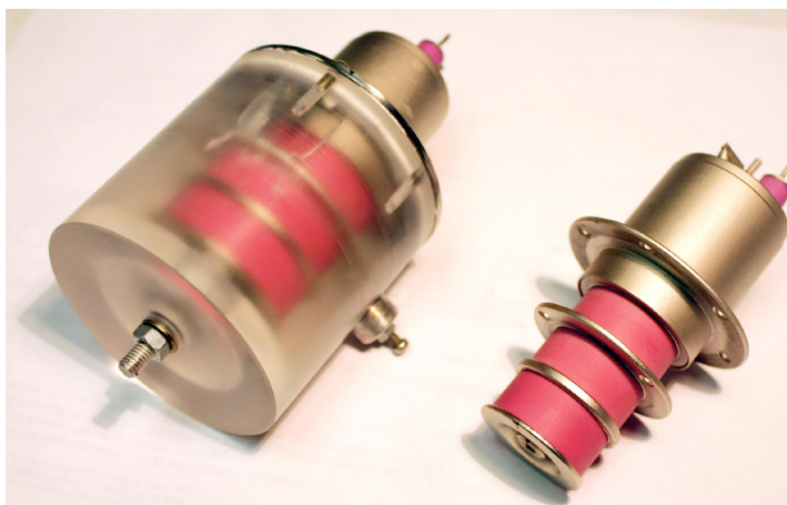
Рис. 3. Тиратрон ТПИ-1К-35 в изолирующем корпусе, заполненный кремний-органической жидкостью (до 40 кВ рабочего напряжения) и без корпуса (до 20 кВ рабочего напряжения).
