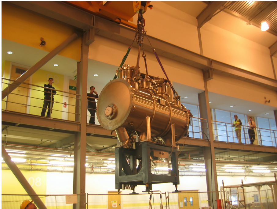
Рис. 32. Монтаж 49-полюсного вигглера с полем 4,3 Т на накопитель DLS (Англия).
