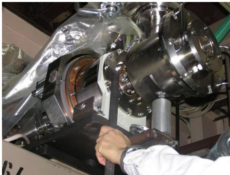
Рис. 31. Левое зеркало с выводным окном.
