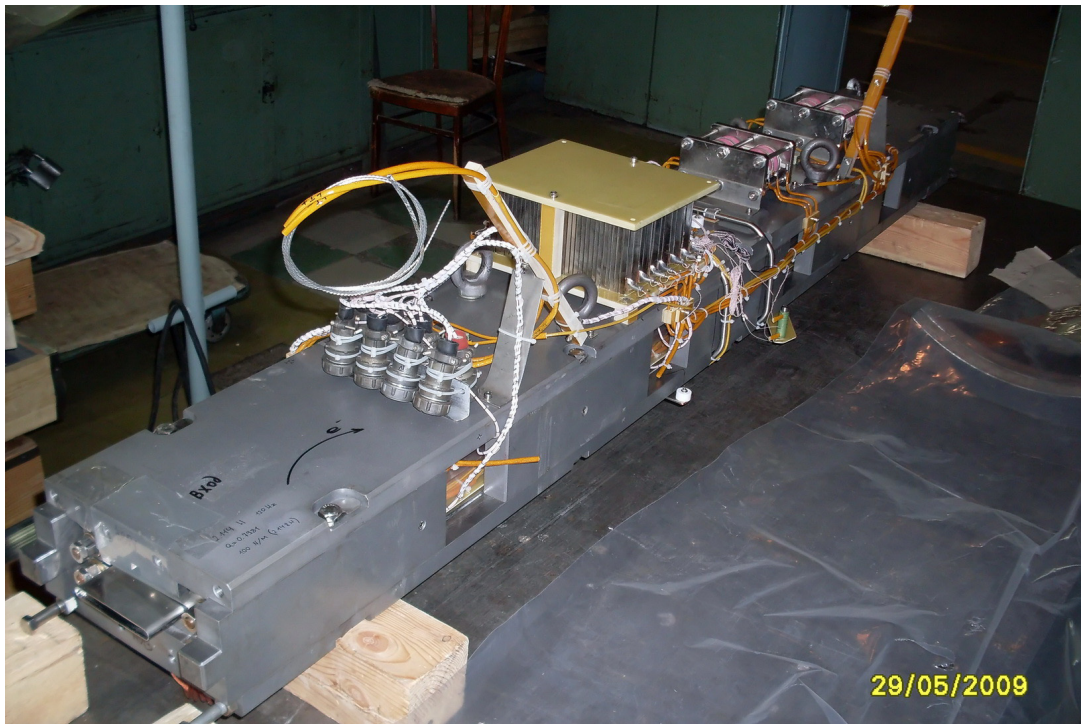
Рис. 35. Магнитная система 119-полюсного вигглера с полем 2,2 Т и периодом 31 мм для накопителя ALBA-CELLS (Испания).
