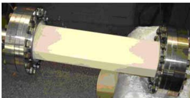
Рис.5.13.19 Керамическая вакуумная камера со стриповым покрытием.
