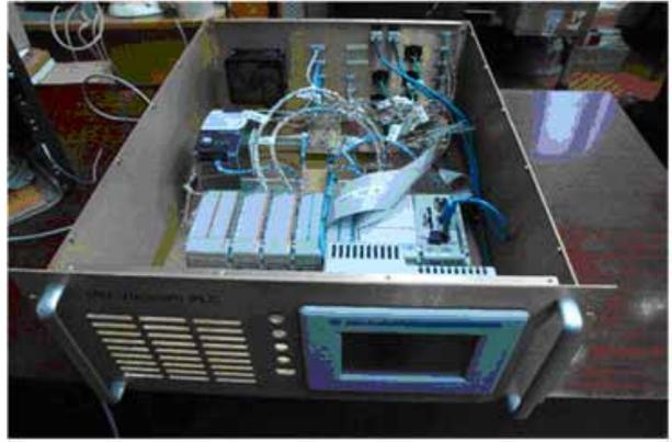
Рис.5.13.23 Шасси с PLC для управления вакуумом канала транспортировки пучка линак- бустер.
