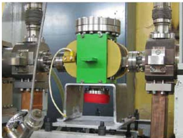
Рис. 5.3. 2. Элемент системы очистки позитронного пучка от электронов.
