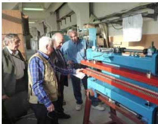
Рис. 6.4.10 Один из трех ондуляторов третьей очереди в процессе сборки.
