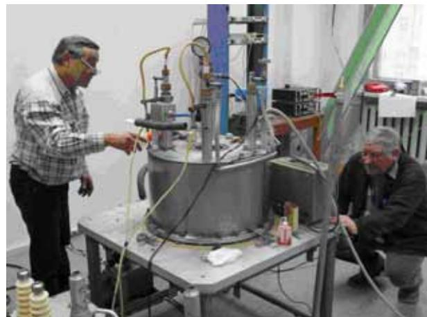
Рис.4.1.22. Фотография одного из смонтированных криогенных магнитов, подготовленных к испытаниям и установке гиротронов.
