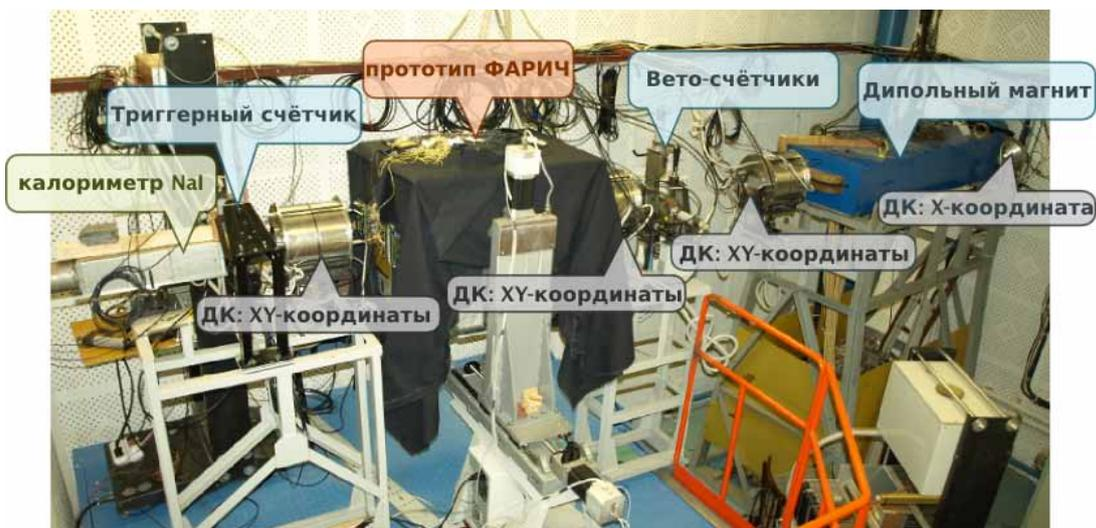
Рис.1.3.3 Экспериментальный зал с компонентами выведенного пучка и прототипом ФАРИЧ.
