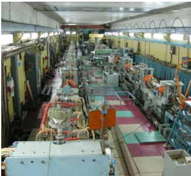
Рис. 5.3. 1. Линейный ускоритель позитронов Инжекционного комплекса.
