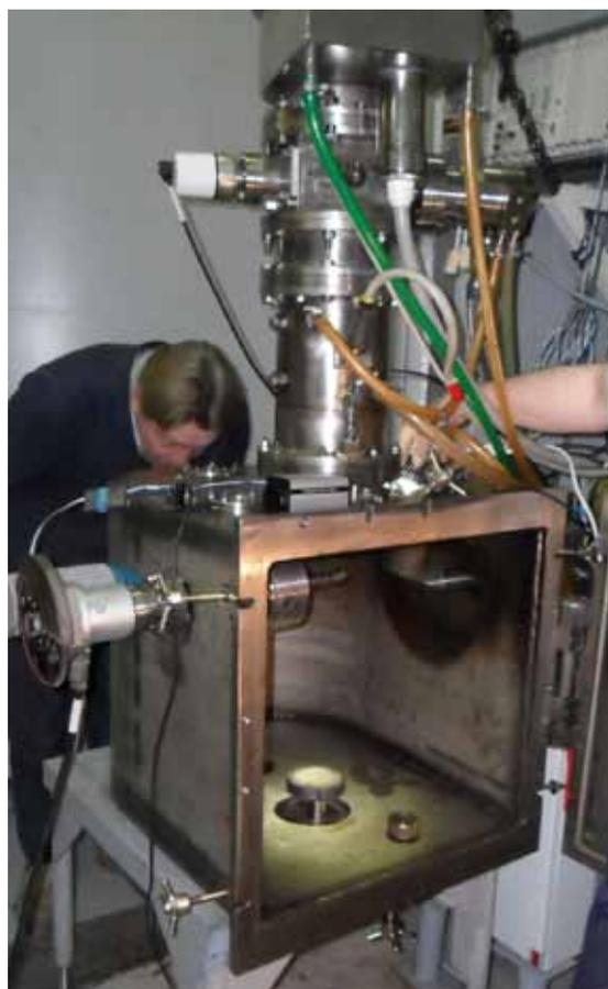
Рис.5.5.2 Электронная пушка на стенде в момент сборки.
