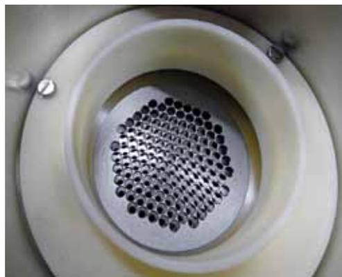
Рис. 4.2.14. Многоапертурная диодная ЭОС, вид со стороны анода (труба дрейфа отсутствует).
