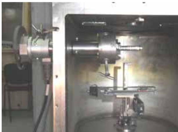
Рис.5.5.1 Вид внутренней части экспериментального стенда для отладки подсистем установки электронно-лучевой сварки.
