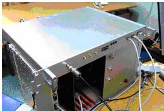
Рис.5.13.11 Полосковый пикап (вверху) и электроника системы измерения бетатронных частот (внизу).
