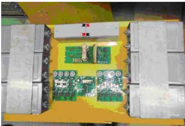
Рис. 4.1.26. Фотография секции рабочего варианта высоковольтного модулятора в процессе наладки.
