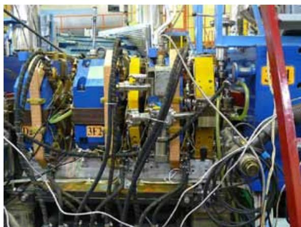
Рис. 5.1.16 Модификация вакуумной камеры для метода ОКР.
