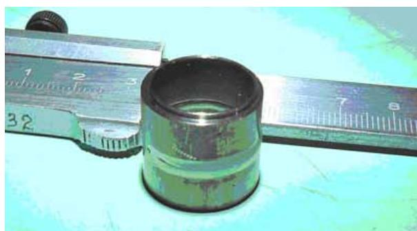
Рис.5.5.3 Сваренный на стенде образец.
