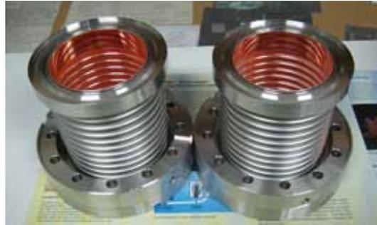
Рис.5.10.6 Компенсатор ускорительной структуры XFEL.
