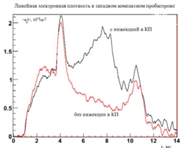
Рис.4.1.3. Линейная плотность электронов в западном КП.
