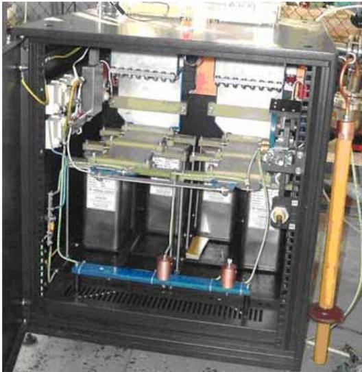
Рис.5.13.18 Тонкостенная вакуумная камера "бамп магнита" с ребрами жесткости и "бамп магнит" на измерительном стенде (вверху). Генератор импульсного питания "бамп магнитов" (внизу).
