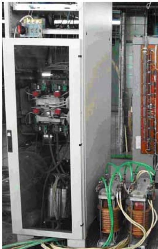
Рис.5.13.12 Источники питания дипольных магнитов ВД сверху. Источник питания для динамических испытаний в ИЯФ внизу.
