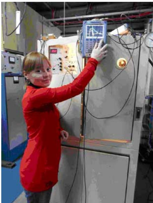
Рис.4.1.24. Пилотный вариант высоковольтного модулятора в процессе испытаний.
