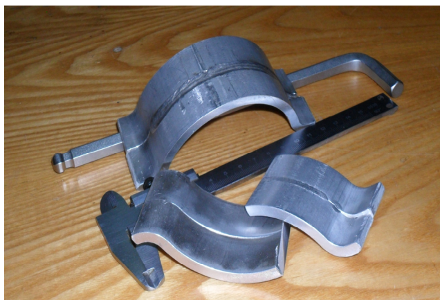
Рис. 5.4.3. Фрагменты вакуумной камеры, сваренные в стенде электронно-лучевой сварки.
