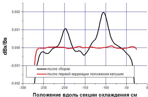
Рис. 5.9.3. Измерения горизонтальной компоненты наклона силовой линии в секции охлаждения до корректировки и после корректировки положения катушек.
