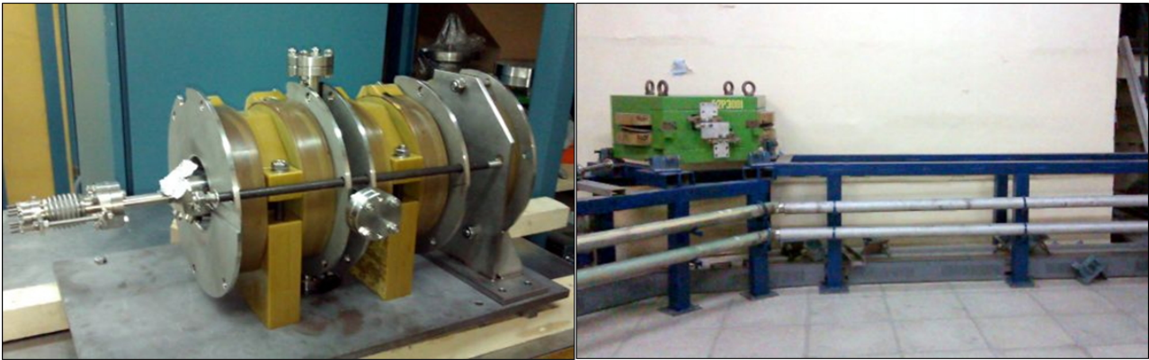
Рис. 5.3.1. Схема первой очереди эксперимента по кильватерному ускорению на Инжекционном комплексе ИЯФ СО РАН (вверху). Короткая плазменная секция (слева внизу). Место для короткой плазменной секции на выпуске пучка из накопителя-охладителя (справа внизу).
