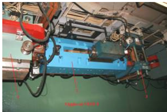
Рис. 5.2.4. 7-полюсный вигглер с полем 3Т, установленный в северном полукольце ускорителя ВЭПП-4М.
