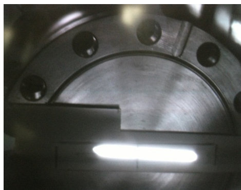
Рис. 6.3.7. Синхротронное излучение канала № 8 из 7-ми полюсной змейки в бункере СИ ВЭПП-4.
