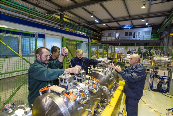
Рис. 7.10.2. Сборка CCDTL модуля №2 в CERN командой ИЯФ.
