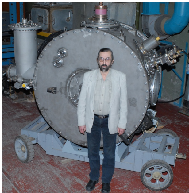
Рис. 7.8.1. Резонатор 181,8 МГц после доработки.
