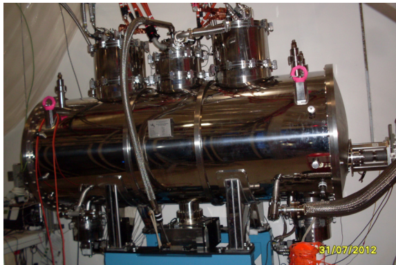
Рис. 6.5.1. 63-полюсный 4 Т вигглер для накопителя Australian Synchrotron (Мельбурн)
