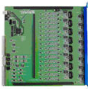
Рис. 1.9.12. Электронный модуль формирователя-оцифровщика в стандарте VME на 16 каналов.
