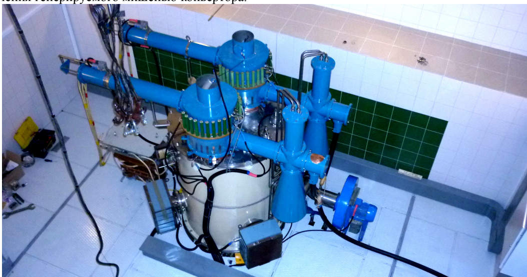
Рис. 8.1.1. Ускоритель ИЛУ-10 в Кольцово, вакуумный бак с резонатором и ВЧ генераторы.
