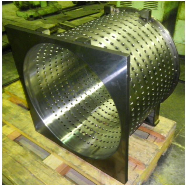
Рис. 7.11.5. Кожух половины резонатора с отверстиями для выхода охлаждающего воздуха.
