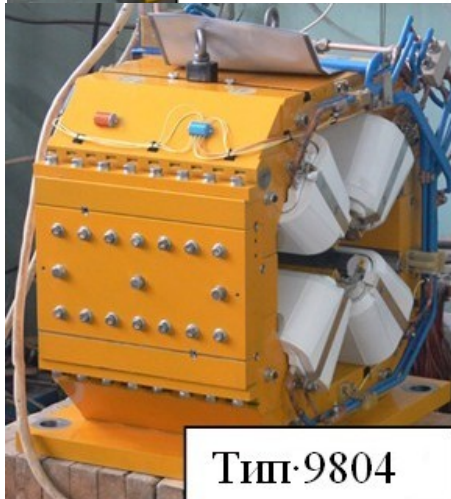
Рис. 5.6.1. Типы линз, изготовленные в ИЯФ СО РАН для основного кольца источника синхротронного излучения NSLS II.
