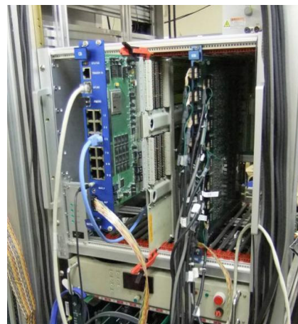
Рис. 1.9.17. Внешний вид VME крейта для калориметрической электроники.
