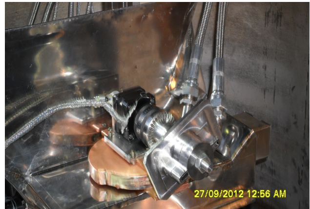
Рис. 5.4.2. Четырёхкоординатная система приводов на шаговых двигателях.
