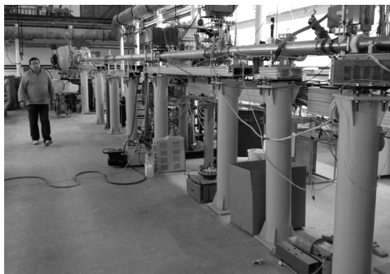
Рис. 6.3.6. Общий вид канала синхротронного излучения № 8 из 7-ми полюсной змейки ВЭПП-4.
