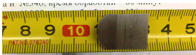
Рис. 8.3.1. Шлиф коронки, зона закалки потемнела.
