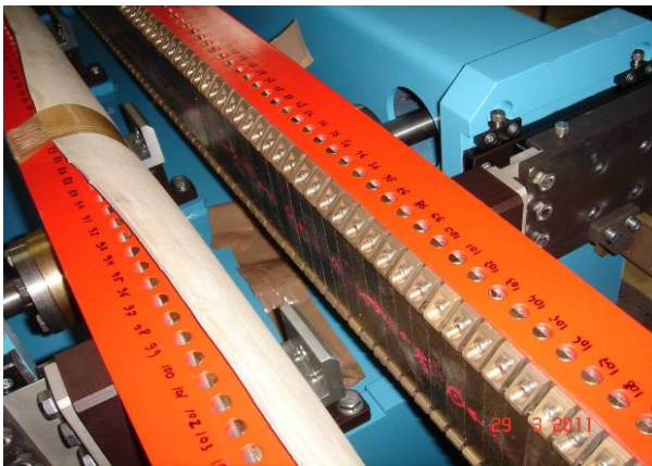
Рис. 6.4.4. Один из трех ондуляторов третьей очереди в процессе сборки.
