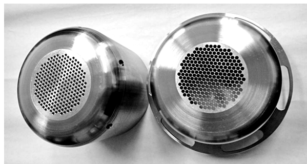
Рис. 4.2.6. Общий вид электродов ЭОС. Слева показан катод, справа – анод.
