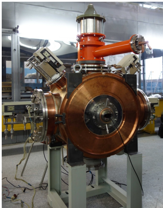
Рис. 7.6.1. Новый резонатор БЭП во время контрольной сборки в ЭП-1.
