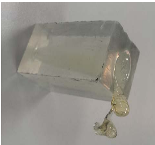
Рисунок 2 - Отверстие в оргстекле, проделанное несфокусированным излучением третьего ЛСЭ.
