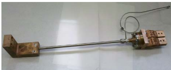
Рисунок 3. Тепловая трубка сифонного типа.
