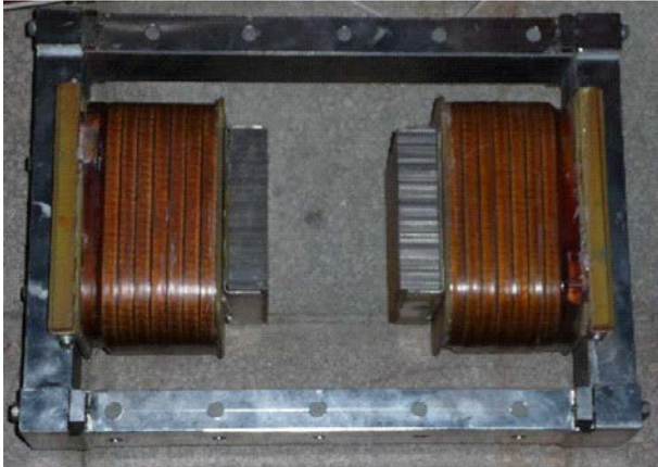
Рисунок 2. Фотография прототипа сканирующего электромагнита.
