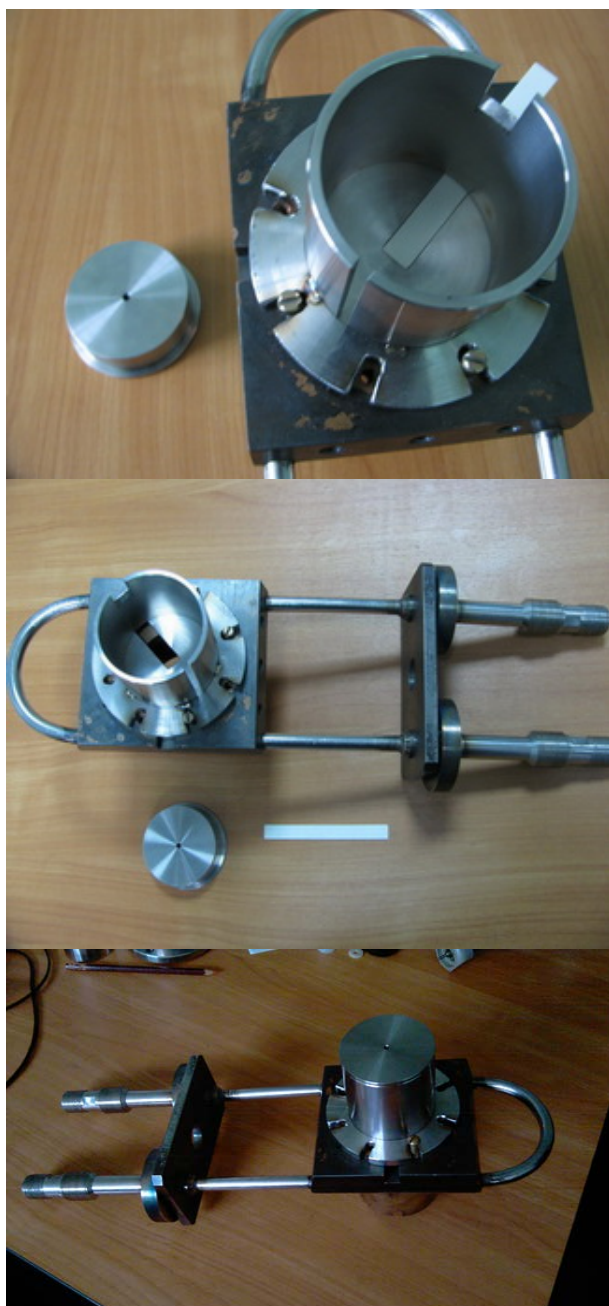
Рисунок 5. Мишень с пластиной из нитрида бора.
