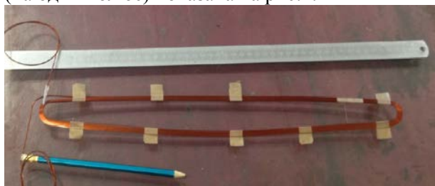
Рисунок 2 Сверхпроводящая обмотка линзы финального фокуса.
