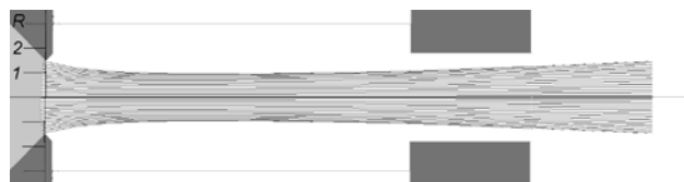
Рисунок 3 – Траектории электронов в отсутствие анодной плазмы.
