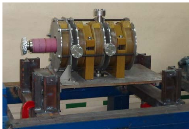
Рисунок 6. Вид изготовленной плазменной секции во время монтажа на установке по кильватерному ускорению
