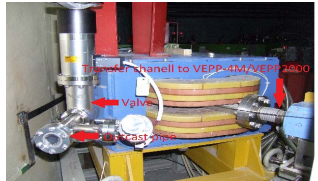
Рисунок 2.5. Выпускной канал накопителя-охладителя ВЭПП-5.
