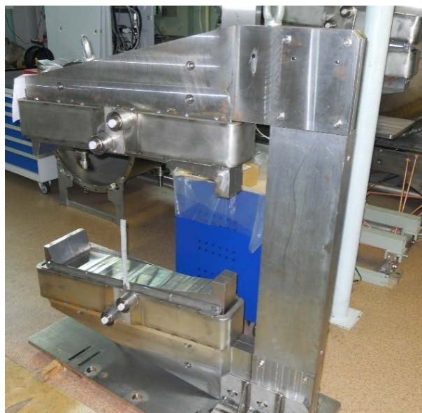
Рисунок 8.2 Фотографии секторного магнита. Вверху – верхний полюс магнита со снятой катушкой, видны постоянные магниты. Внизу - секторный магнит в сборе.
