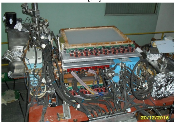
Рисунок 10.1. Вверху: гистограмма, демонстрирующая пространственное разрешение дрейфовой камеры, измеренное на стенде с помощью космических частиц. Внизу — фотография контрольной сборки блоков дрейфовых камер на экспериментальном промежутке с элементами поляризованной мишени.
