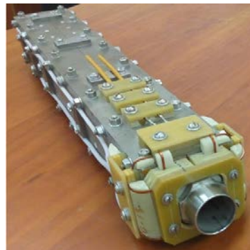
Рисунок 5.1. Чертеж общего вида линзы финального фокуса с торца.
