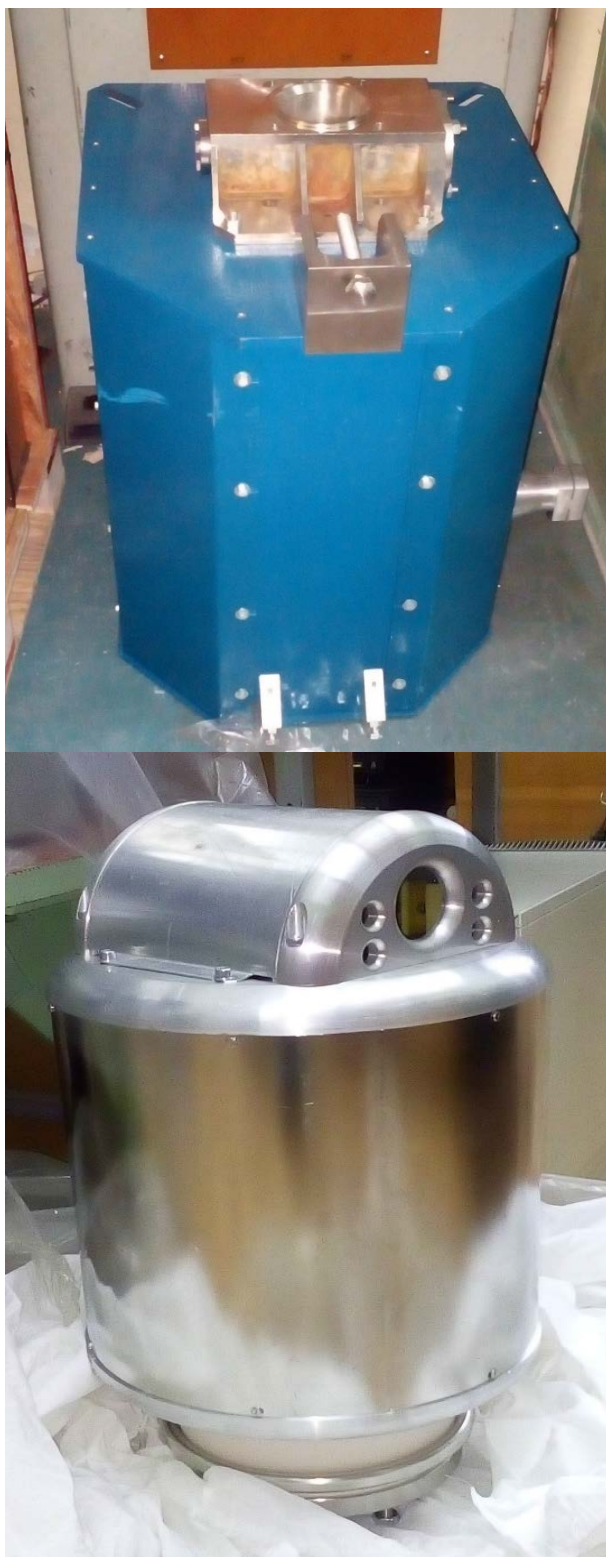
Рисунок 12. Элементы инжектора первичного пучка: вверху — магнитный экран инжектора (номер 5 на Рис.10), справа — вакуумная камера инжектора (большой цилиндр соответствует номеру 4 на Рис.10, полуцилиндр сверху — электростатический экран, закрывающий место разделки кабеля питания, внизу — керамический изолятор, соответствует номеру 3 на Рис.10).
