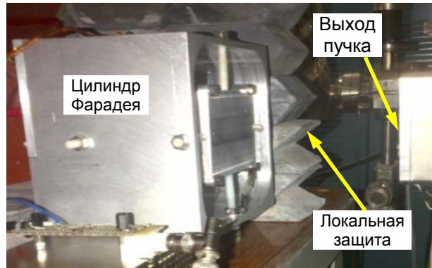
Рисунок 4.1. Цилиндр Фарадея в экспериментальном зале инжекционного комплекса ВЭПП-5 во время теста под пучком.
