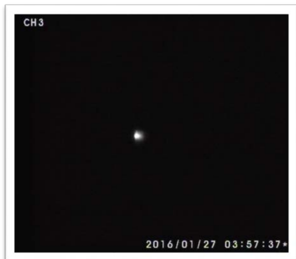
Рисунок 2.1 Синхротронное излучение первого захваченного в БЭП циркулирующего пучка электронов.
