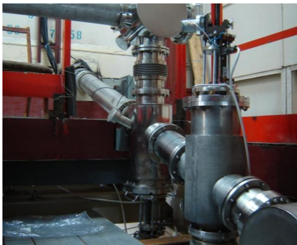
Рисунок 2.1 Часть канала вывода излучения на пользовательские станции, находящаяся в ускорительном зале. Видны оптические коммутаторы для ввода излучения второго (слева дальше) и третьего (справа ближе) ЛСЭ в общий канал вывода.
