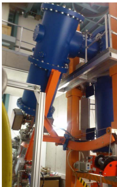
Рисунок 1. Собраный ускоритель ЭЛВ-4 с наклоненной ускорительной трубкой.
