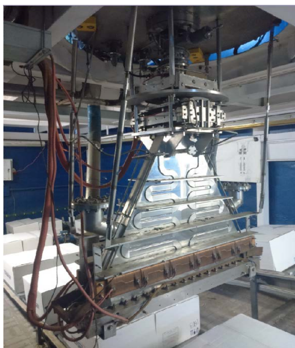
Рисунок 10. Новая система развёртки и выпуска электронного пучка для ускорителей серии ИЛУ была изготовлена и установлена на ускорителе ИЛУ-10.
