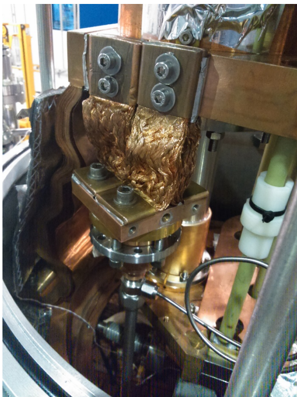
Рисунок 6. Реконденсорная часть азотной тепловой трубки, соединенная со ступенью криокулера 60 К.
