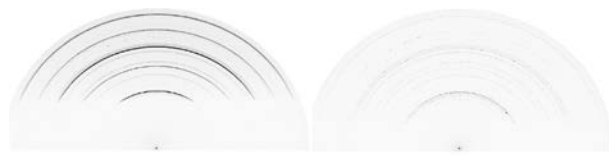
Рисунок 7.1 Двухкоординатные рентгеновские дифрактограммы поверхности композита до облучения (слева) и после (справа).
