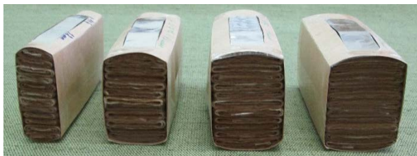
Рисунок 3.1. Конденсаторные секции, собранные в ячейки ФЛ.
