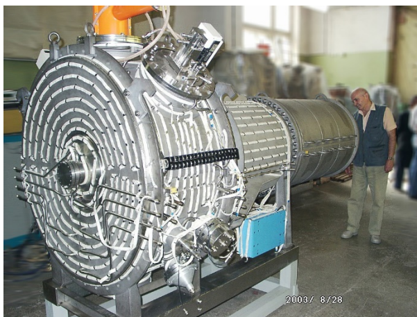
Рисунок 7. Резонатор с поглощением высших мод на 180 МГц.
