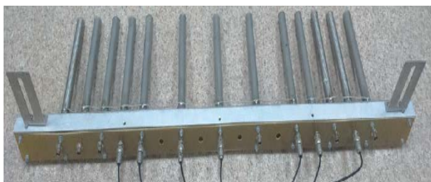
Рисунок 12. Набор датчиков тока для измерения равномерности дозного поля.
