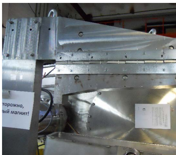
Рисунок 8.1 Расположение секторных магнитов в вакуумной камере низкоэнергетического тракта.
