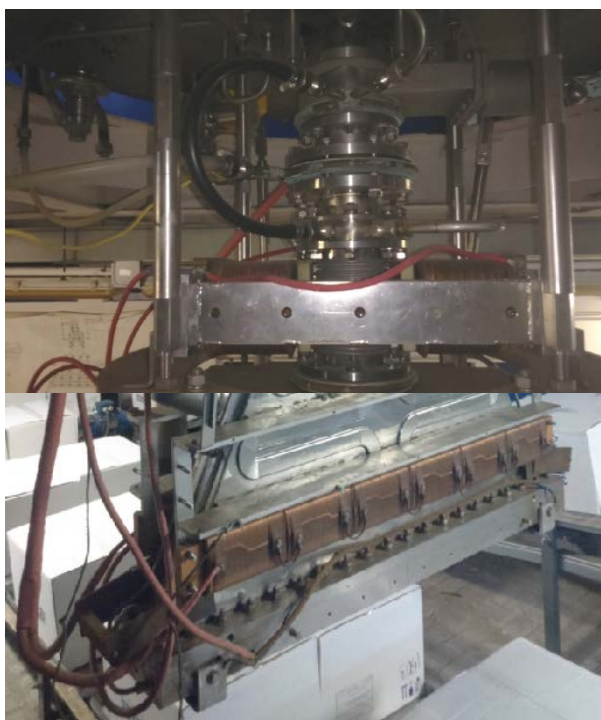
Рисунок 11. Сильфонный узел и электромагнит коррекции(вверху) и линза Панофского (внизу).
