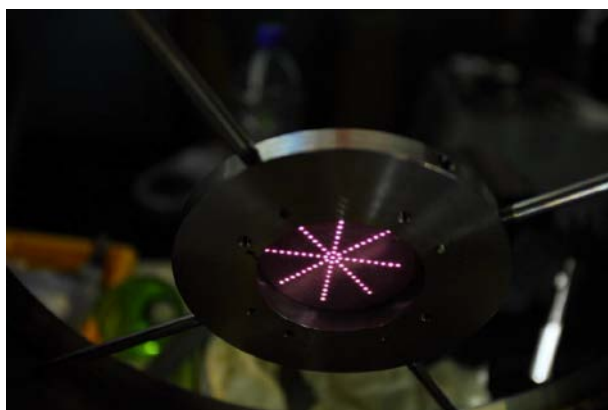
Рисунок 3.3. Падение света от точечного источника на расстоянии 720 мм от матрицы на керамический экран.
