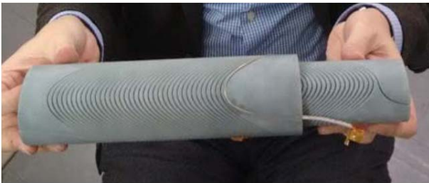
Рисунок 4.1. Схема намотки двухслойной сверхпроводящей линзы со спиральными обмотками (вверху). Оправка для намотки прототипа линзы (внизу).
