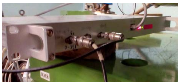
Рисунок 13. Пикап №11 на кольце накопителя-охладителя (вверху) и его пикап-станция (внизу).
