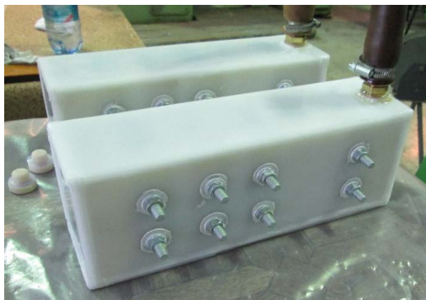
Рисунок 3.3. Сборка ФЛ в корпусе при заполнении жидкой изоляцией.
