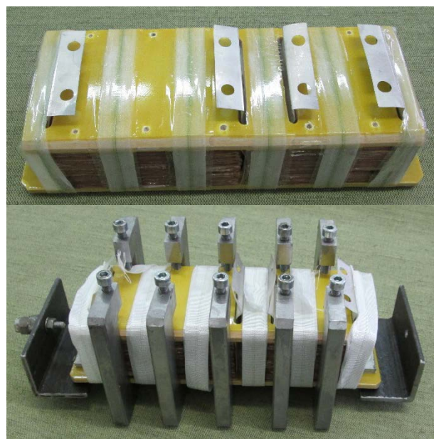
Рисунок 3.2. Ячейки ФЛ в сборе (сверху), сжатие ФЛ струбцинами и наложение бандажа (снизу).
