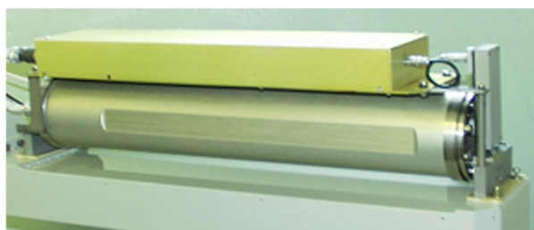
Рисунок 4. Вид детектора на базе МИС. Сверху – внешняя электроника.
