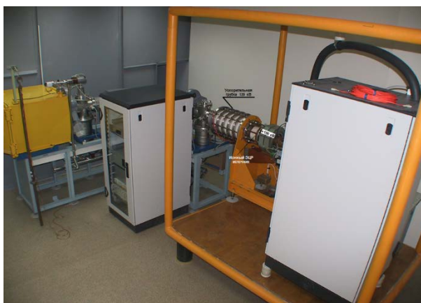
Рисунок 9.1 Экспериментальная установка для изучения доускорения ионов в трубке.
