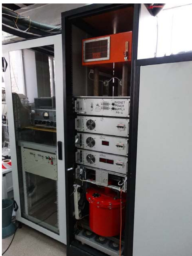
Рисунок 2.2. Стойка питания и управления источником отрицательных ионов водорода.
