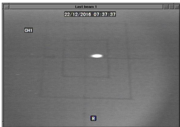
Рисунок 15. Изображение пучка электронов на датчике 5PL3 (К-500 в сторону ВЭПП-4М).
