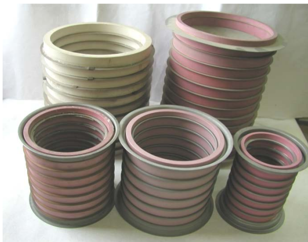
Рисунок 2.1. Изоляторы для УТ на основе керамика 22ХС, изготовленные по технологии пайки активными припоями без металлизации.
