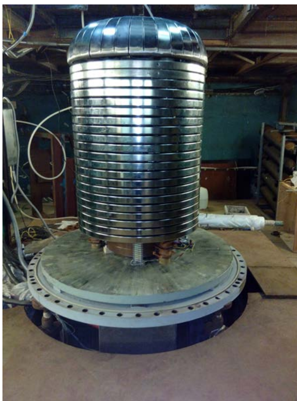
Рисунок 2. Выпрямитель с секциями, собранными по схеме с учетверением напряжения.
