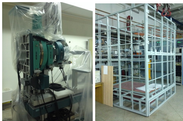
Рисунок 14.1. Дифрактометр HUBER 5020 (слева). Пьедестал дифрактометра и каркас бокса радиационной защиты в сборе (справа).
