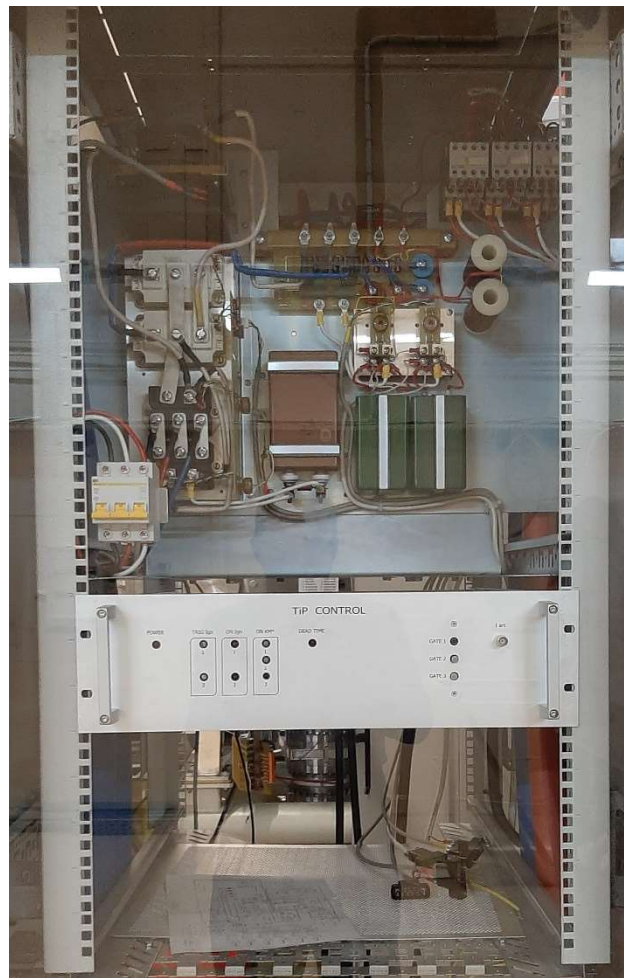
Рисунок 8. Система питания титановых испарителей.
