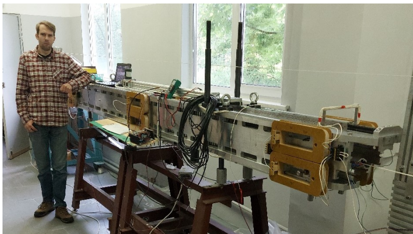
Рисунок 19. Ондулятор на стенде окончательной настройки. Видны жёлтые корректирующие катушки.
