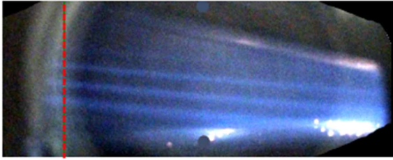
Рисунок 5. Свечение остаточного газа под действием сфокусированного пучка в области приёмных пластин калориметра (вид снизу).
