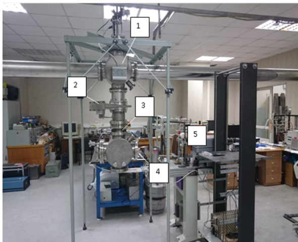
Рисунок 24. Устройство перископического поворотного вывода излучения: 1 – подвижное зеркало, 2 – шиббер, 3 – поворотный механизм, 4 – выходное окно, 5 – станция «Исследования химических радикалов».
