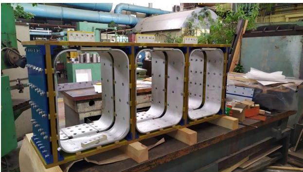
Рисунок 14. Каркас со вторичными обмотками модернизированного ТСТ 400-10000/36.
