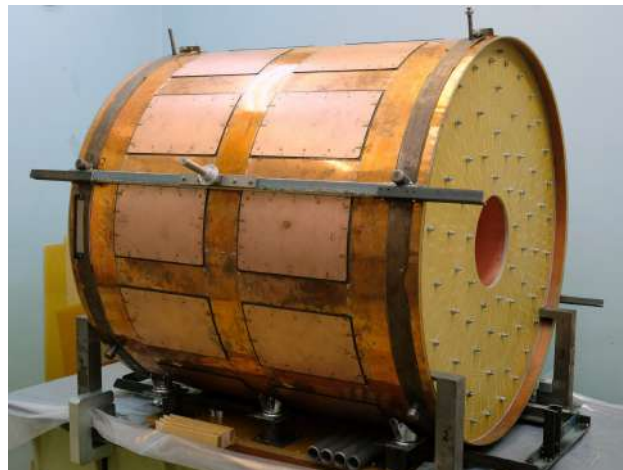
Рис. 7: Корпус дрейфовой камеры.
