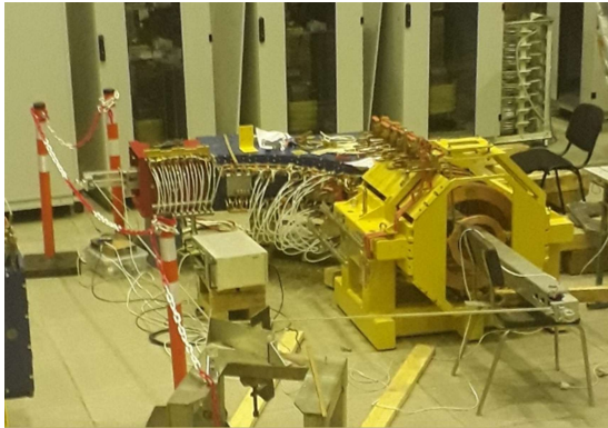
Рисунок 2. Система измерения магнитного поля для последовательного измерения на участках: прямая-поворот-прямая (слева). Справа показано измерение продольного магнитного поля в поворотном магните.
