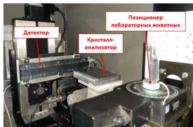
Рисунок 78. Стенд для проведения томографической съемки лабораторных животных.
