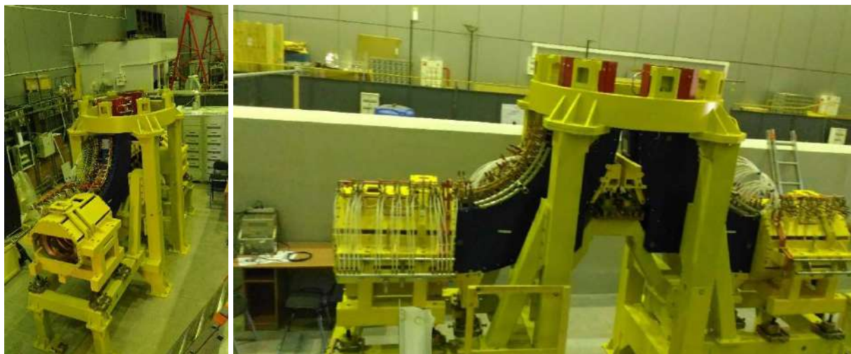
Рисунок 4. Магнитные элементы СЭО расположенные в области электростатического ускорителя.
