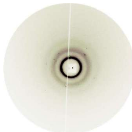
Рисунок 68. Дифракционные данные от образца из стали 10 снятого при температуре плавления.
