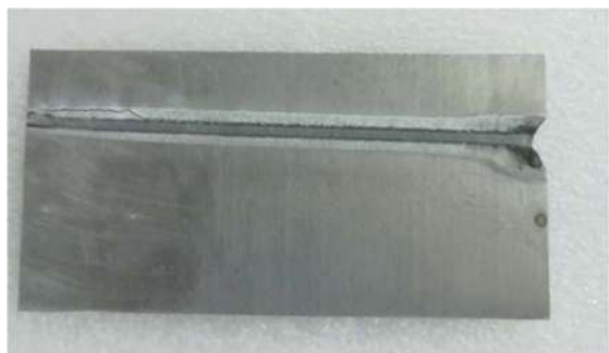
Рисунок 75. Окисление образца из алюминиевого сплава.
