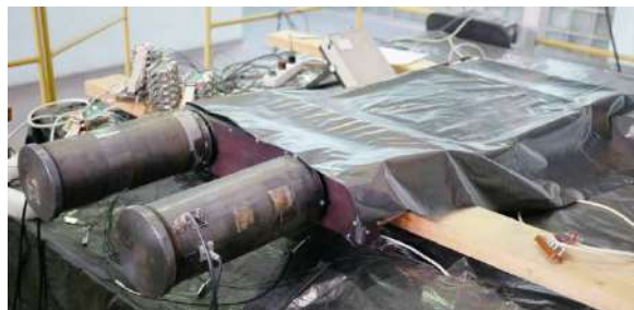
Рисунок 2. Новые тонкие сцинтилляционные счетчики для нижнего плеча на стенде для проверки и калибровки на космических частицах.
