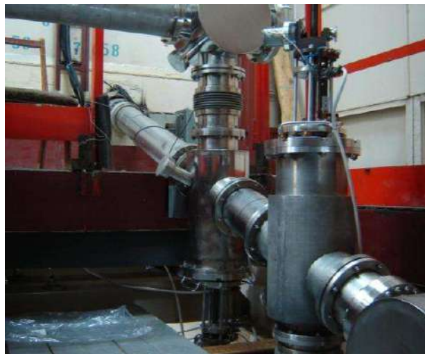
Рисунок 4. Система переключения излучения от разных ЛСЭ. Излучение всех ЛСЭ выводится на одни и те же пользовательские станции. Переключение между ЛСЭ осуществляется за счёт убирающихся зеркал.
