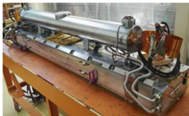
Рисунок 2. Магнитная система 119-периодного ондулятора с периодом 15,6 мм и полем 1,2 Тл в сборе.
