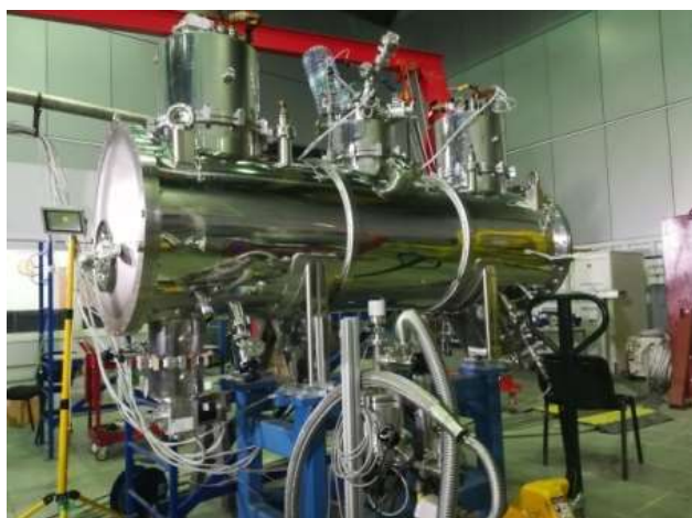
Рисунок 3. Сверхпроводящий ондулятор с периодом 15,6 мм и уровнем магнитного поля 1,2 Тл в собственном криостате косвенного охлаждения в сборе.
