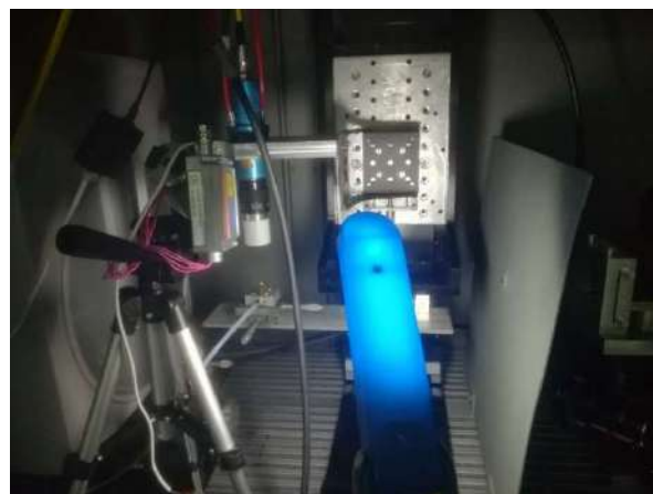
Рисунок 66. Установка для проведения рентгеноструктурных исследований с использованием аэродинамической левитации
