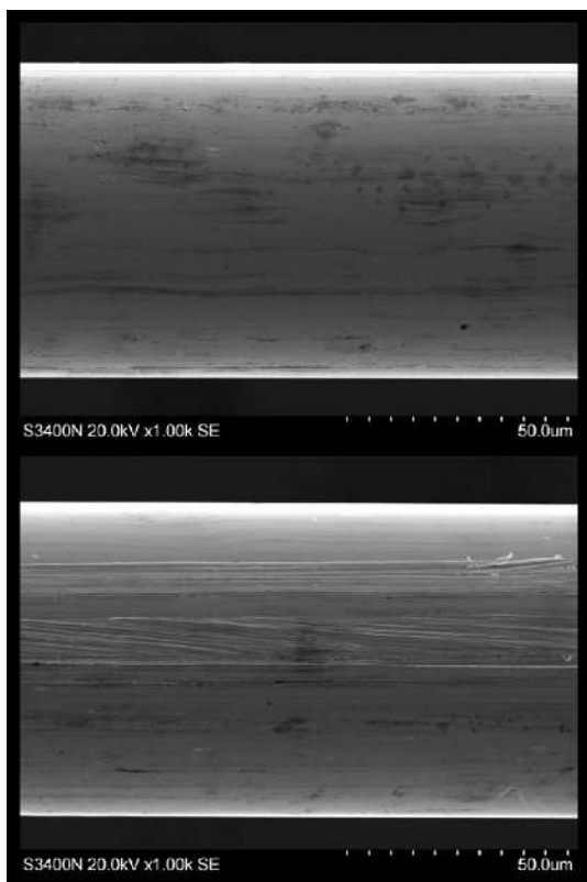
Рис. 7: Изображение проволоки диаметром 70 мкм, полученное с помощью электронного микроскопа.
