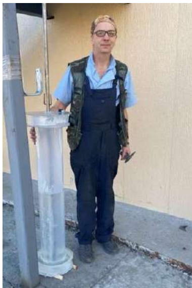
Рисунок 81. Изготовление вакуумного объема ускорителя. Стадия изготовления – полимеризация объема вместе с фланцами.
