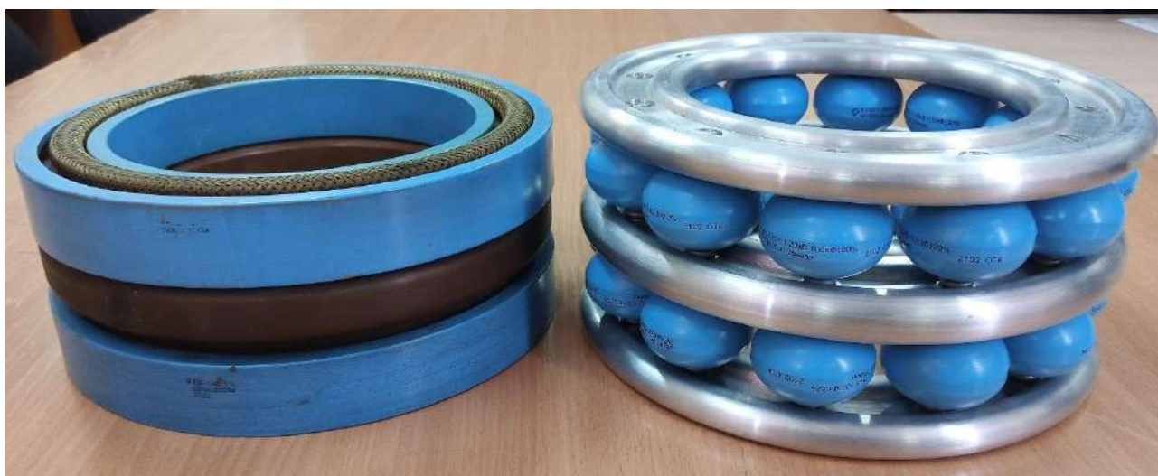
Рисунок 7. Старый (слева) и новый (справа) блоки разделительных конденсаторов ВЧ каскадов.
