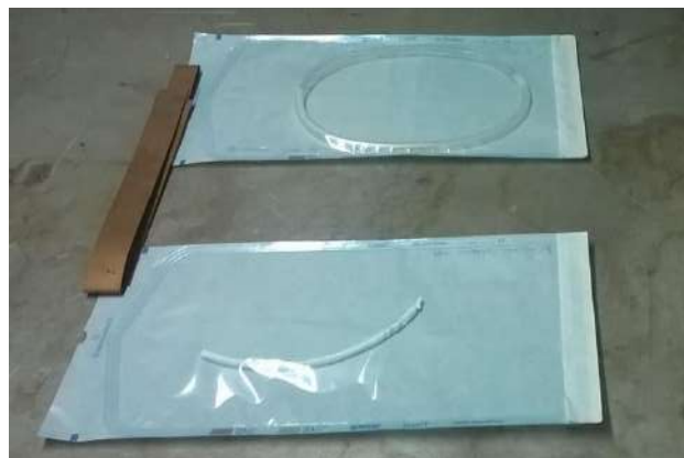
Рисунок 1. Герметично упакованные протезы сосудов под выпускным окном ускорителя.
