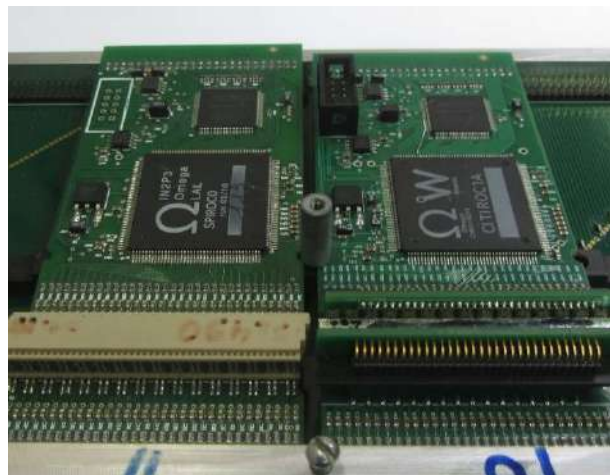
Рисунок 2. Фотография 32-х канальной платы регистрации старого образца (слева) и нового варианта с повышенным быстродействием (справа).
