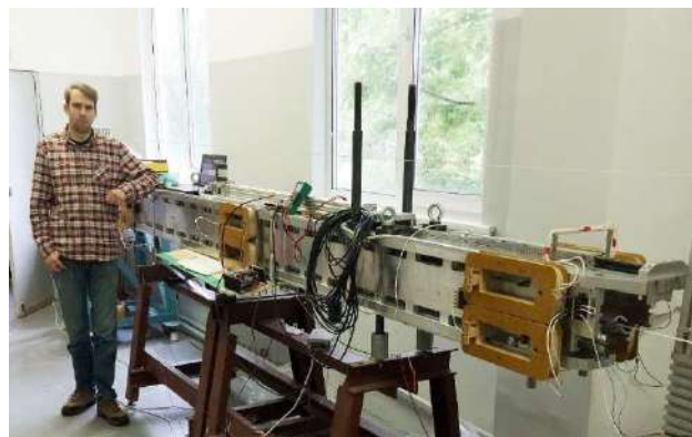
Рисунок 8. Фотография ондулятора, установленного на стенде магнитных измерений. В середине и на концах ондулятора видны обмотки коррекции магнитного поля.
