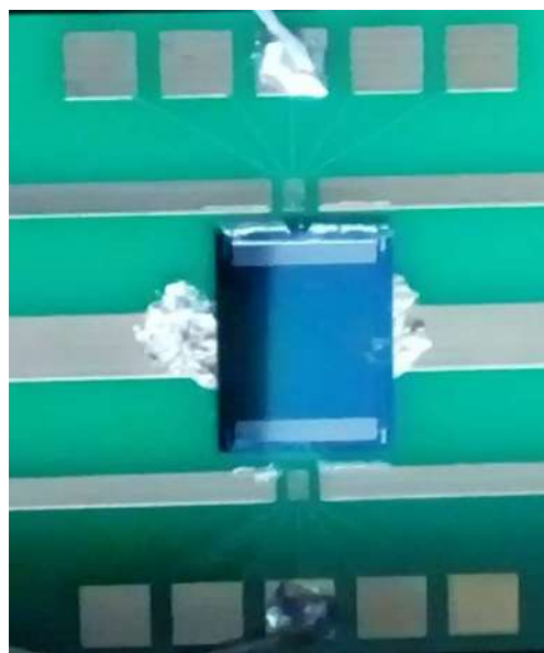
Рисунок 27. Микрополосковый сенсор из GaAs:Cr, смонтированный для измерений.
