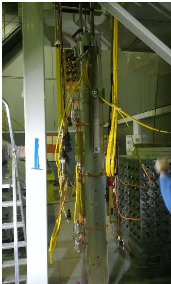
Рисунок 1. Магнитная система 84-полюсного вигглера с полем 4,7 Тл и периодом 48 мм перед испытанием в жидком гелии.
