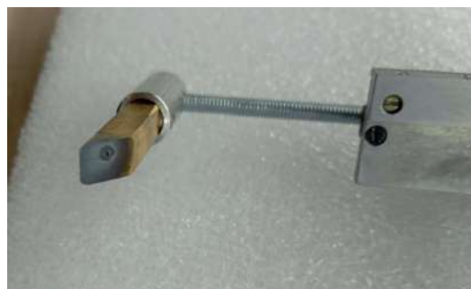
Рисунок 73. Прогорание зеркала, отражавшего лазерное излучение.
