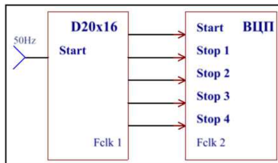
Рисунок 15. Измерение с несинхронными Fclk.
